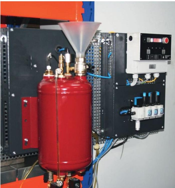
*Die Schmiermittelversorgung über das von Eckardt entwickelte Dosiersystem lässt sich maschinen- und zeittaktabhängig regulieren.*
